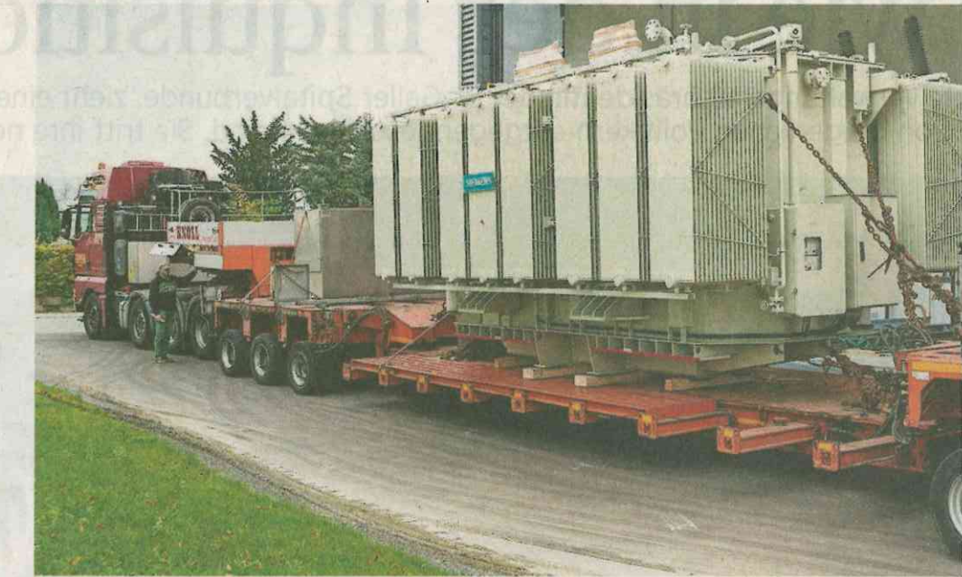
Ein Tieflader liefert einen 63 Tonnen schweren Grosstransformator beim EKT-Unterwerk Bischofszell ab.
